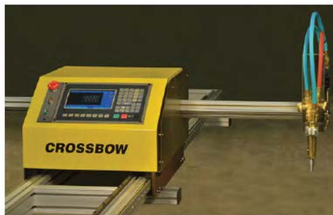
Maksymalna grubość cięcia w przypadku cięcia gazowego – do 80 mm.
