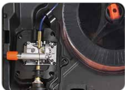
Modele Kempact 181/251 posiadają 2-rolkowy mechanizm podający GT02C.
