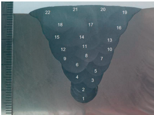
Rys. 3. Układ ściegów w rowku V 60°; grubość spoiny 35 mm, grubość blachy 50 mm; drut proszkowy EC309L \phi 3,2 mm; 450 A; 31 V; 50 cm/min; 22 ściegi
