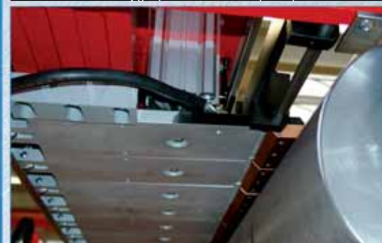
Einzelansteuerbare Spannbacken (über Pneumatikzylinder)
