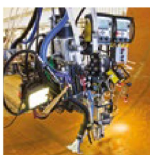
Konfiguracja TANDEM ze sterownikiem PEK
